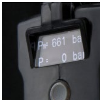
Indicateur OLED multifonction tactile
