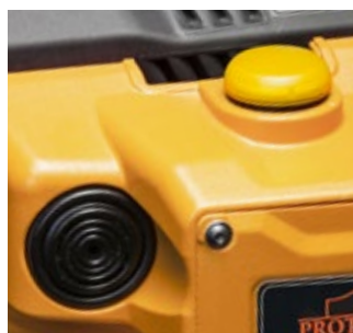
Indicateurs LED et buzzer
