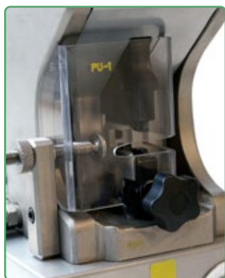
PNB-1 détail de la zone de sertissage avec protection PU-1.
