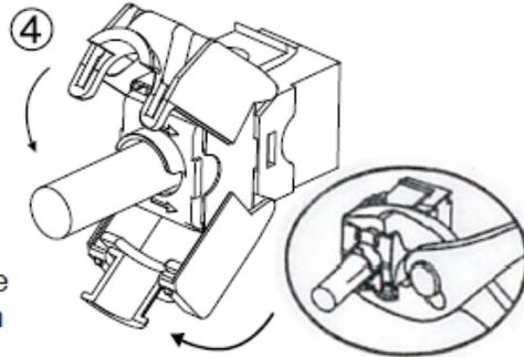
④ Schließen Sie die Flügel per Hand oder mit einer Crimpzange, bis diese vollständig einrasten, um die Adern zu kontaktieren.
