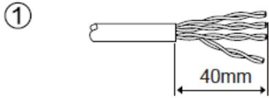
① Ziehen Sie 40mm des Kabelmantels ab, stülpen Sie das Schirmgeflecht nach hinten und wickeln dieses um das Ende des Kabelmantels. Entfernen Sie die Aluminiumfolie für jedes Adempaar.
