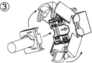
③ Schieben Sie die Adervorsortierung in Pfeilrichtung in das offene Modul, wodurch die Adern zugewiesen werden.
