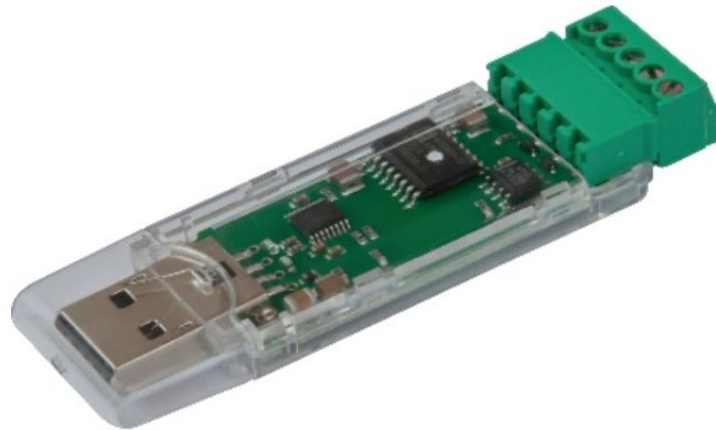
Abbildung 7: USB-to-RS485 Adapter, bestellbar auf www.tele-online.com mit der Bezeichnung S-USB485
